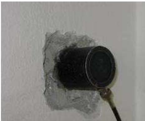
Lettura diretta della velocità di propagazione delle onde - particolare
