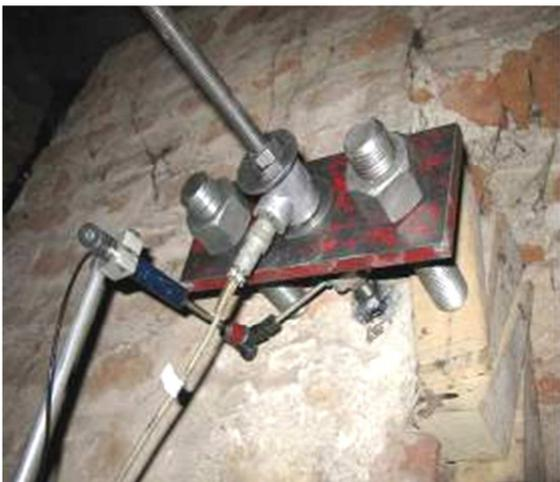
Sistema di tiro e di strumentazione di catena
