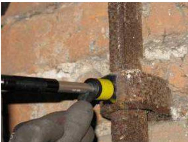
Prova durometrica. Deduzione della classe di resistenza meccanica
