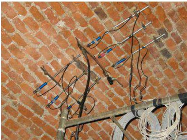
Strumentazione Con martinetto piatto durante la prova di carico di una volta a botte
