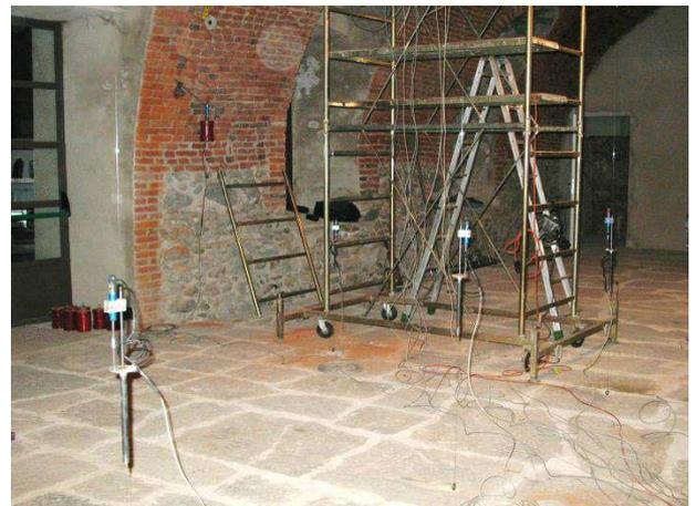
Verifica della deformata orizzontale dei reni della volta soggetta a prova di carico
